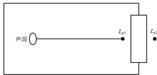
图 5.4-1 室内声源等效为室外声源图例
