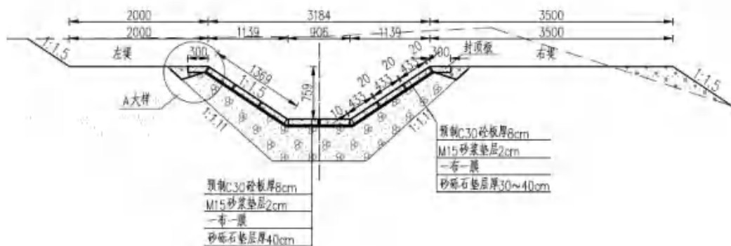
图 3 老双河干渠断面示意图
