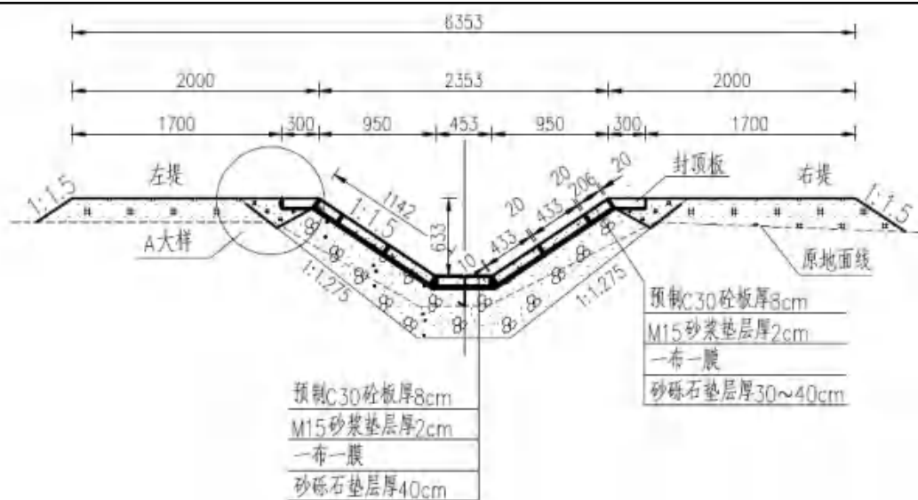
图 6 三支渠断面示意图
