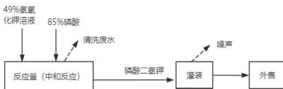
图 3.2-4 一期磷酸二氢钾溶液生产工艺流程及产污环节示意图
